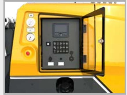
Zentrales Bedienfeld mit intuitivem Keypad mit „Folge dem blauen Licht“-Prinzip – einfach und sicher zu bedienen, bestens geschützt durch robuste Plexiglas-Tür.
