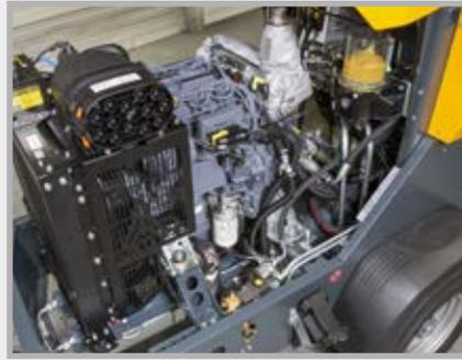
Leistungsstarker 3-Zylinder Deutz Motor mit 55,4 kW dank Ladeluftkühler erfüllt alle Anforderungen des gültigen Emissionsstandards „Stage V“ in der EU sowie in der Schweiz.
